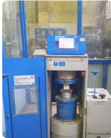
(صوره ١٥) توضح جهاز قياس قوه تحمل الضغط لمكعبات أحد الخلطات التجريبية ©تصوير الباحثة
