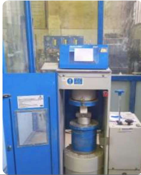
(صوره ١٥) توضح جهاز قياس قوة تحمل الضغط لمكعبات أحد الخلطات التجريبية ©تصوير الباحثة
