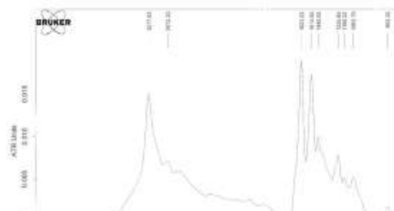
شكل رقم (١): يوضح نتائج التحليل بالأشعة تحت الحمراء للألياف الحمراء، وأوضحت أن المادة الصابغة المستخدمة هي الكرثامين Carthamin.
