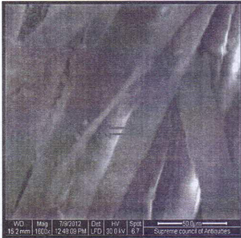
(صورة ١٦) تآكل الطبقة السطحية للألياف
