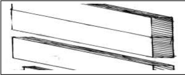
(شكل رقم ٤ ) يوضح طرق وصل وتثبيت الألواح الخشبية بسقف مسجد الأمير حسن بأخميم
