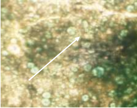
صورة رقم ( ١٨ ) تصوير بالميكروسكوب الضوئي لعينة لون أصفر فاتح من طبقة لون مسجد الأمير حسن بأخميم يوضح أن اللون هو مزيج من اللون الأصفر وأبيض الكالسييت - قوة تكبير ٤٠
