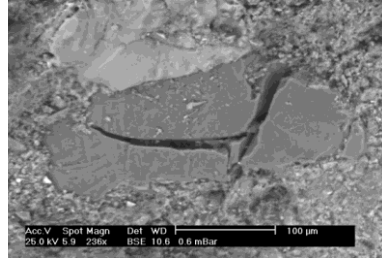
صورة رقم (٢٣) توضح وجود وانتشار الفقاعات داخل سطح طبقة التزجيج، باستخدام الميكروسكوب الإلكتروني (٥٤)
