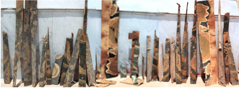
شكل رقم (١٩) مجموعة من أخشاب الغير مطابقة للمواصفات الابلاكاش الناتجة من القبة ( ترميم خاطئ) سابق
